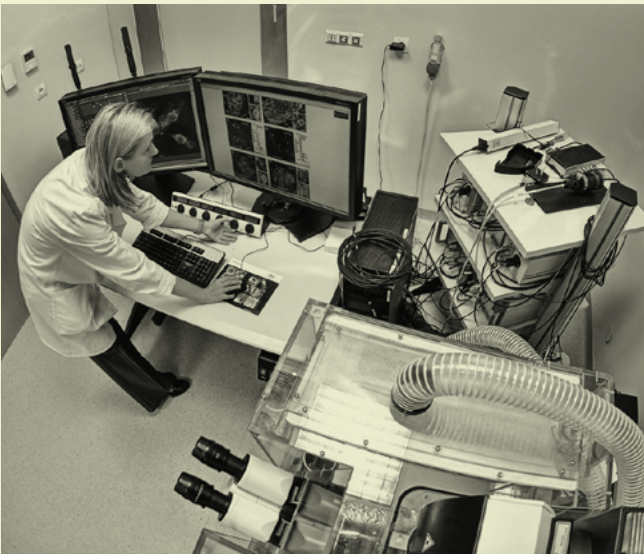
◀ IL. 6 Mikroskop wykorzystujący komorę do badań przyży- ciowych. (Źródło: Instytut Nenckiego PAN)
